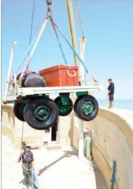
Le palan permet de hisser rapidement les bagages et les vivres des gardiens dans la cour intérieure du phare.
