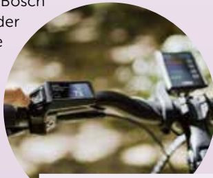
Die Bedieneinheit Purion 200 mit Farbdisplay kann bei Bedarf mit einem zweiten Display kombiniert werden
